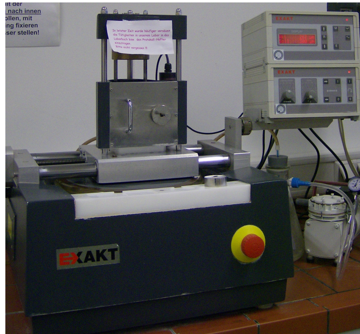
Resim 3-7: 300 \mu kalınlığında hazırlanan mine kesitlerinin 100 \mu kalınlığa inceltilmesinde kullanılan zımpara makinası (Exakt Mikroschleifsystem 400 CS)
