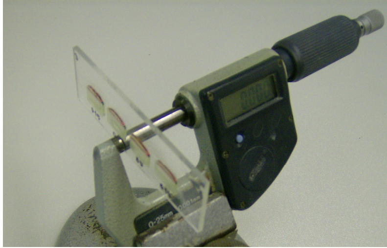
Resim 3-8: Dijital mikrometre kumpası (Mitutoyo, Japonya)
