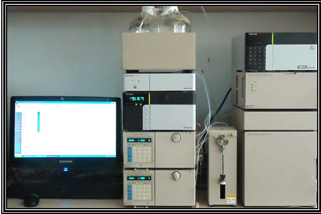
Şekil 3.5. Çalışmada kullanılan HPLC sistemi.
