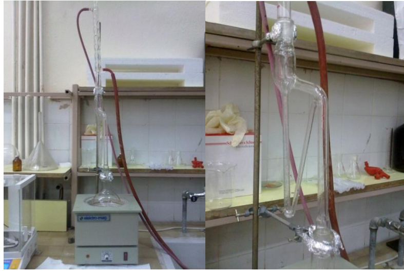
Şekil 3.10. Su destilasyonu sistemi ve Clevenger cihazının yakından görünüşü.
