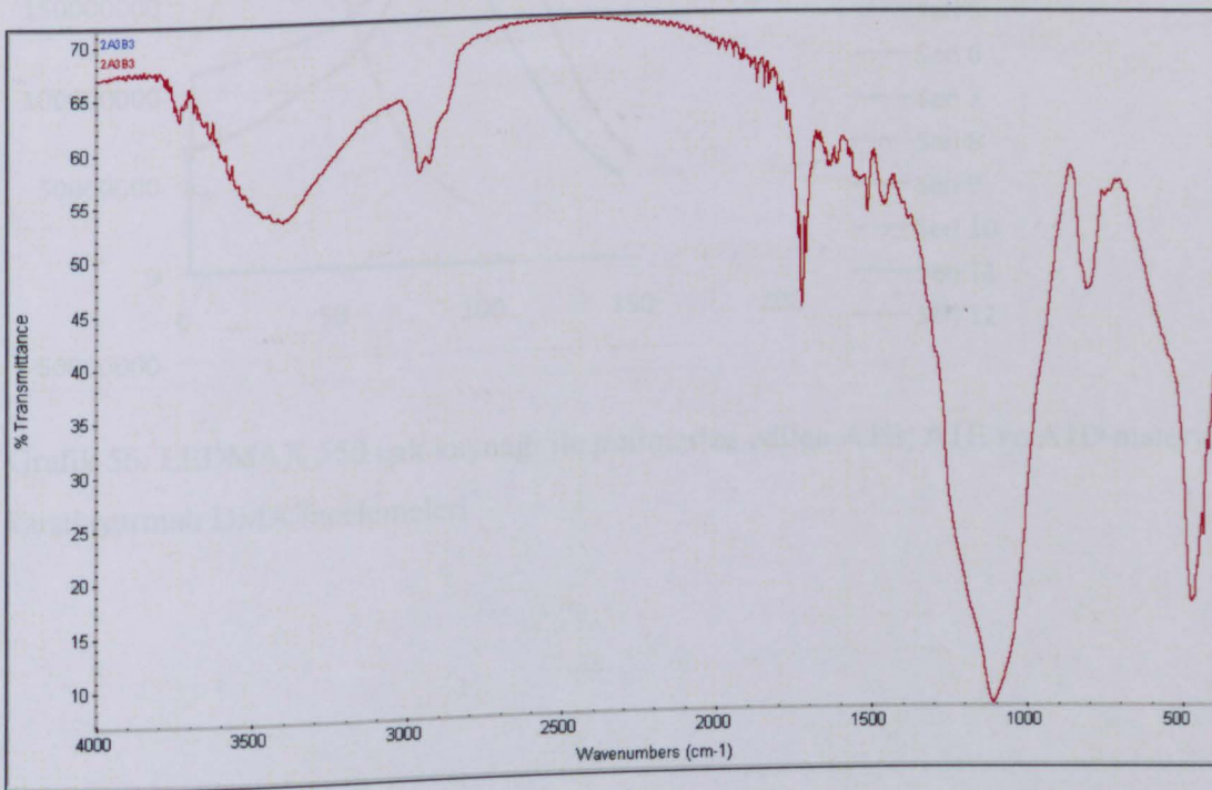
Grafik 54: Freelight Elipar II ile polimerize edilen A3D materyalinin en alt bölgesinden alınan örneğin FT-IR spekturmu
