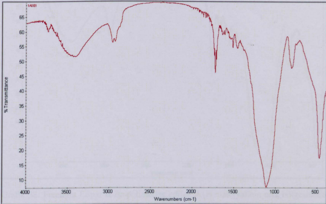
Grafik 36: LEDMAX 550 ile polimerize edilen A3D materyalinin en alt bölgesinden alınan örneğin FT-IR spekturmu
