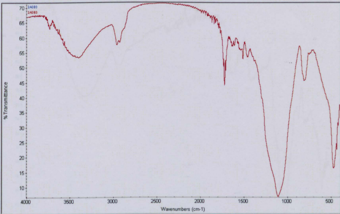
Grafik 48: Freelight Elipar II ile polimerize edilen A3B materyalinin en alt bölgesinden alınan örneğin FT-IR spekturmu
