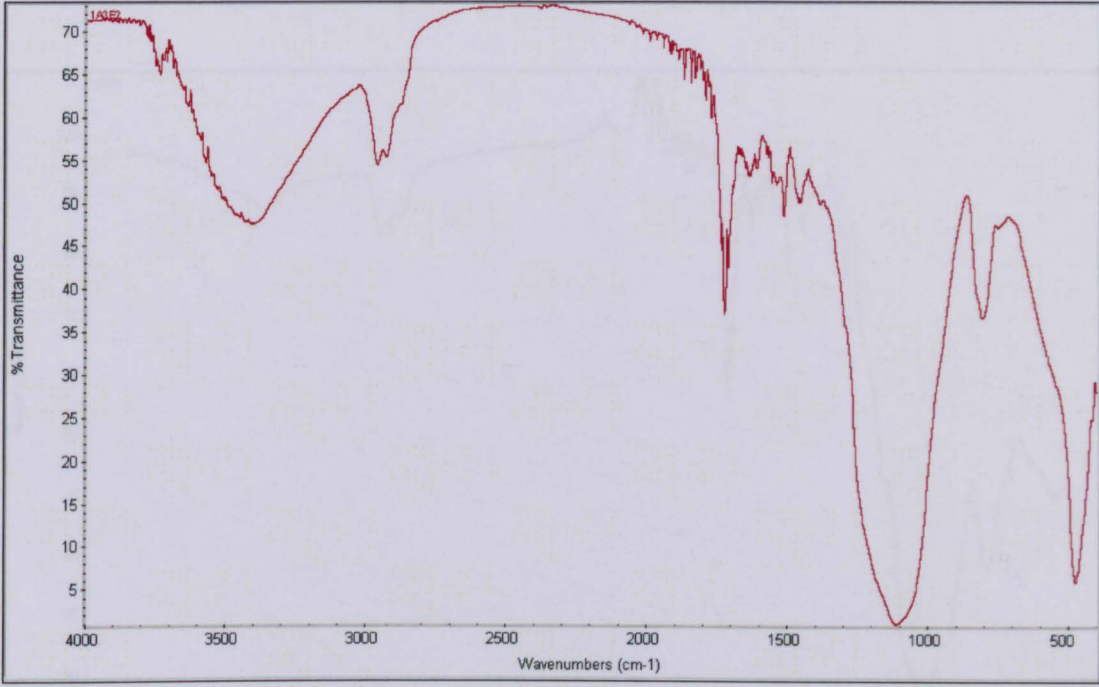
Grafik 37: Freelight Elipar II ile polimerize edilen A1B materyalinin en üst bölgesinden alınan örneğin FT-IR spekturmu
