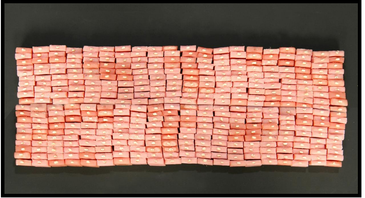
Şekil 3-32: Kırma deneyi sonrası örnekler
