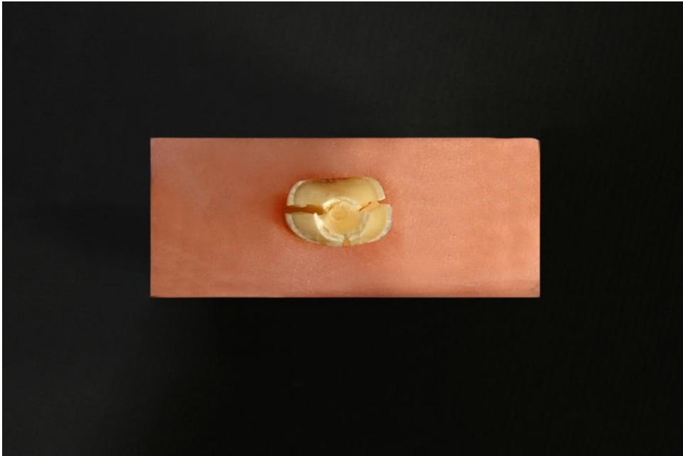
Şekil 3-35: Kontrol 2- .04 Taper - Kırma deneyi sonrası alınan fotoğraf
