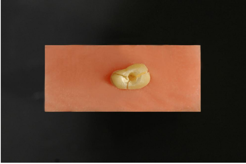
Şekil 3-34: Kontrol 2- \text{Ca(OH)}_2 + .04 Taper - Kırma deneyi sonrası alınan fotoğraf
