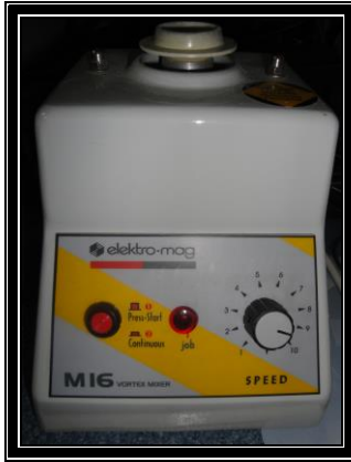
Şekil 3-1: Girdaplı tüp karıştırıcı, vortex cihazı (Elektro-mag, Türkiye)
