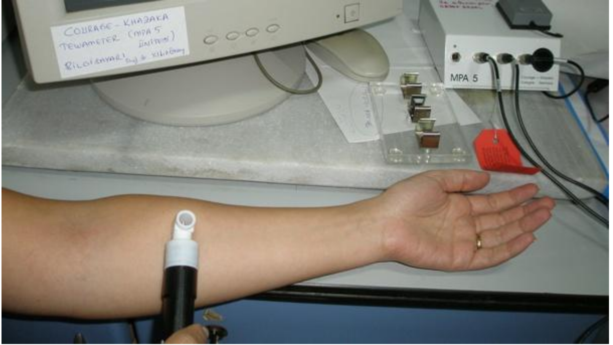
Şekil 3-2: Deri üzerinden gerçekleşen su kaybının Tewameter cihazı ile ölçülmesi
