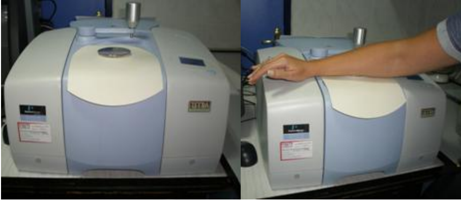
Şekil 3-4: ATR-FTIR Spektroskopisi analizlerinin gerçekleştirilmesi
