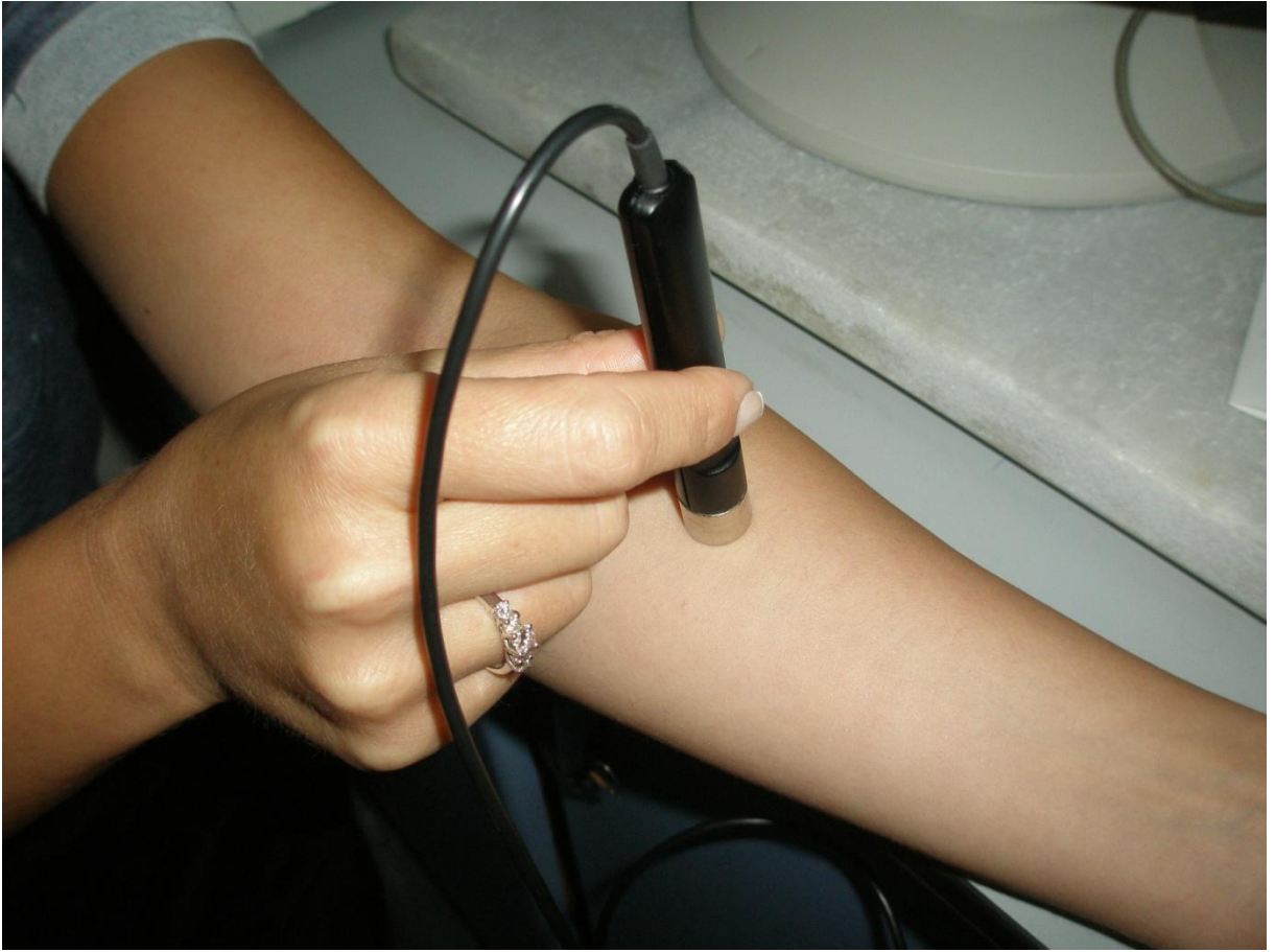
Şekil 3-3: Deri neminin Corneometer cihazı ile ölçülmesi
