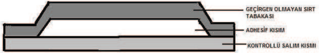
Şekil 2-6: Membran Kontrollü Sistemlerin Yapısı
