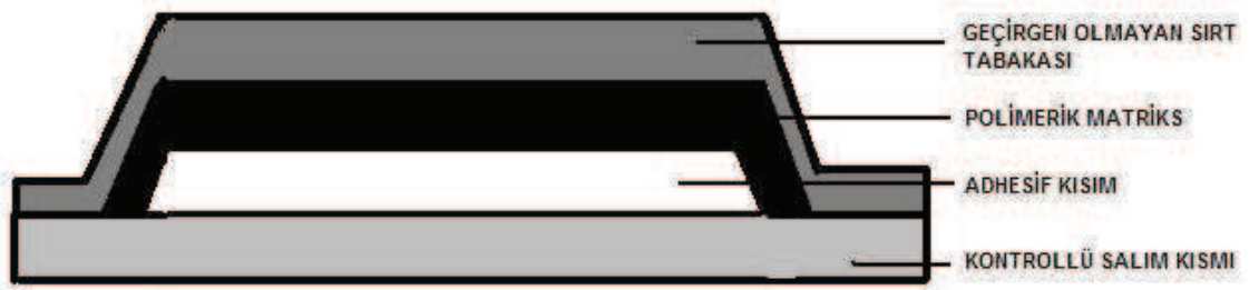
Şekil 2-8: Matriks tipi kontrollü sistemlerin yapısı
