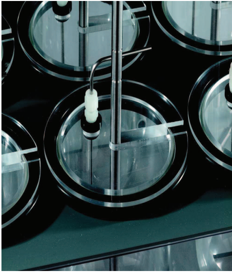
Şekil 3-2: Transdermal yamalar için çözünme testi düzeneği
