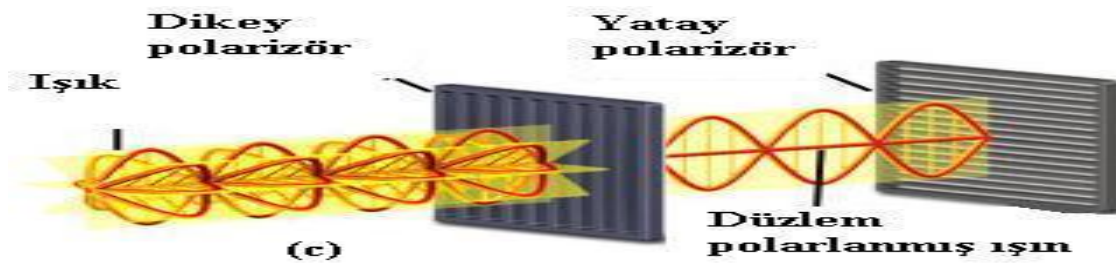
Şekil 46 Düzlem-Polarlanmış, Monokromatik Bir Işık Demetinin Gösterimi : (a)Yayılma Yönü ve Birbirlerine Dik Açıda Olan Elektrik ve Manyetik Alanları (b) Elektrik Vektörünün İki boyutlu Gösterimi (c) Dikey ve Yatay Polarizör Arasında Işının Düzlem Polarlanması (193, 194)
