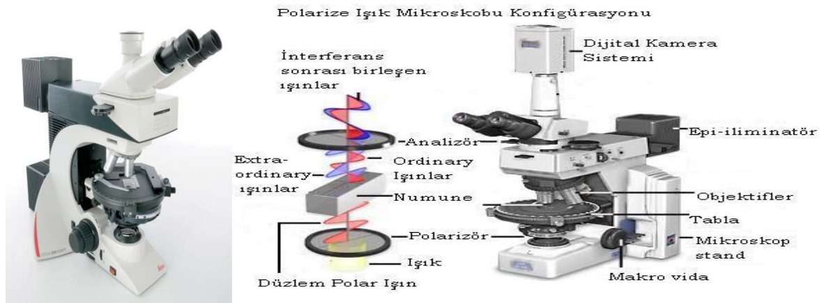
Şekil 54 Leica 2500 P Polarize Işık Mikroskobu ve Işığın; Polarizör, Örnek ve Analizörle Etkileşim Sonrası Durumu (194, 195)
