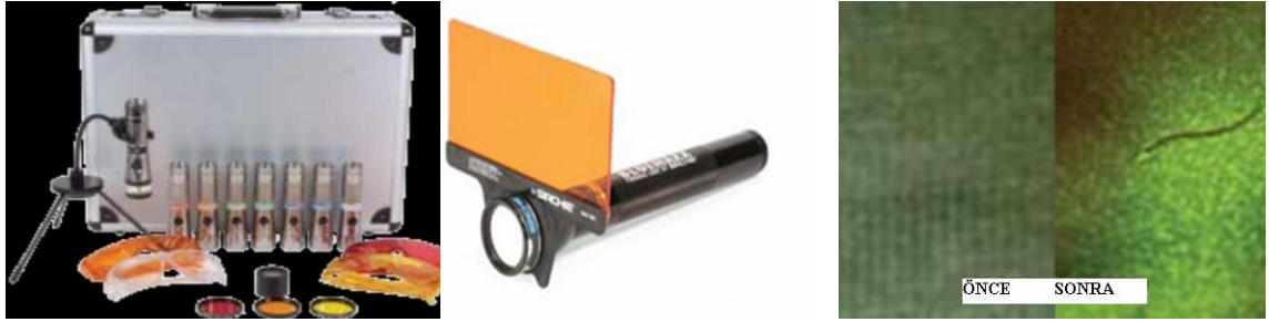
Şekil 40 Alternatif Işık Kaynakları, Lifi Işık Kaynağı Kullanılmadan ve Kullanıldıktan Sonra Görünürlüğü (183)
