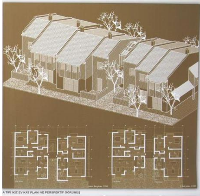
Plan 3 1. Grup 2 Nolu Yenileme Alanı Mimari Avan Projesi A Tipi kız Ev Kat Planları ve Perspektif Görünü ü( BB)
