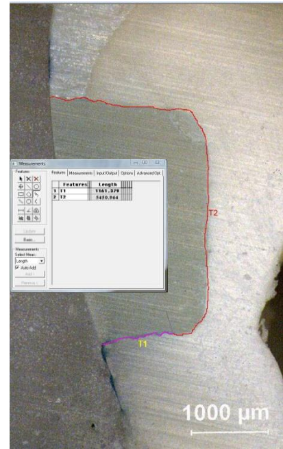
Şekil 4-11: Frez+asit+Single Bond uygulanmış gruba ait mikrosızıntı görüntüsü ve mikrosızıntı düzeylerinin ölçümü (OM:0, GM:%17,56).
