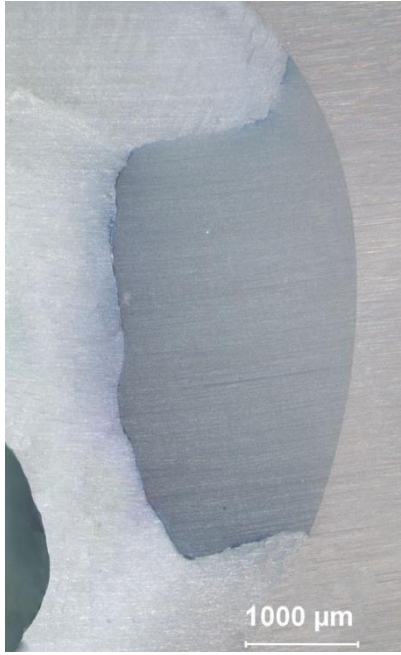
Şekil 4-15: Frez+AdperSE bond uygulanmış gruba ait mikrosızıntı görüntüsü ve mikrosızıntı düzeylerinin ölçümü (OM:%11,7, GM:%72,61).
