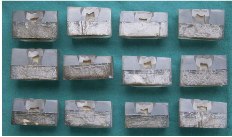
Şekil 3-24: Altın-palladyum ile kaplanmış örnekler.
