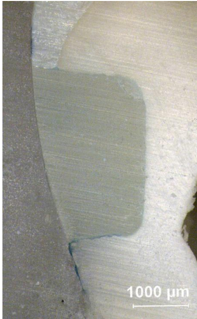
Şekil 4-11: Frez+asit+Single Bond uygulanmış gruba ait mikrosızıntı görüntüsü ve mikrosızıntı düzeylerinin ölçümü (OM:0, GM:%17,56).
