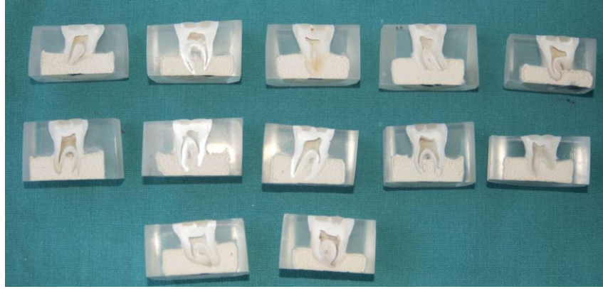
Şekil 3-23: Elmas kesme diski ile kesim sonrası rezin-dentin bağlanma ara yüzlerinin açığa çıkarılması.
