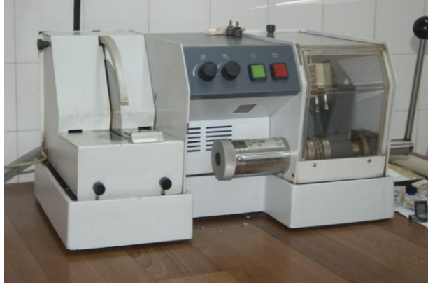
Şekil 3-12: İnce kesitlerin elde edilmesinde kullanılan Discoplan TS cihazı.
