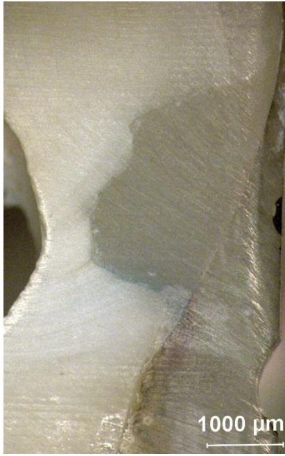
Şekil 4-5: Er:YAG+YAG pür.+Single Bond uygulanmış gruba ait mikrosızıntı görüntüsü ve mikrosızıntı düzeylerinin ölçümü (OM:0, GM:%22,8).
