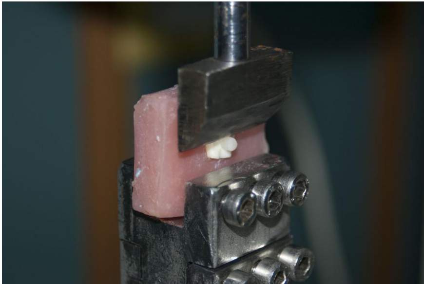
Şekil 3-18: Makaslama bağlanma dayanımı için hazırlanan düzenek.
