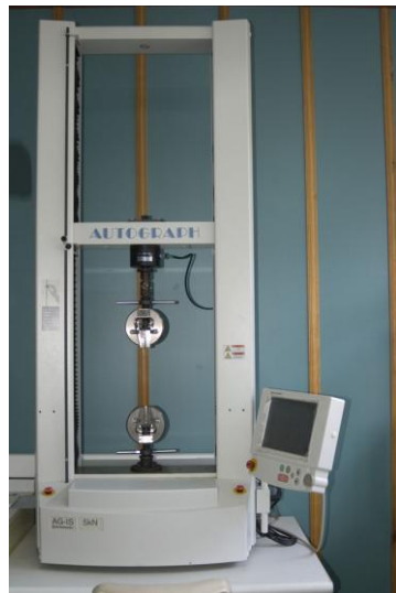
Şekil 3-10: Makaslama baęlanma dayanımının ölçülmesinde kullanılan Instron Universal test cihazı.
