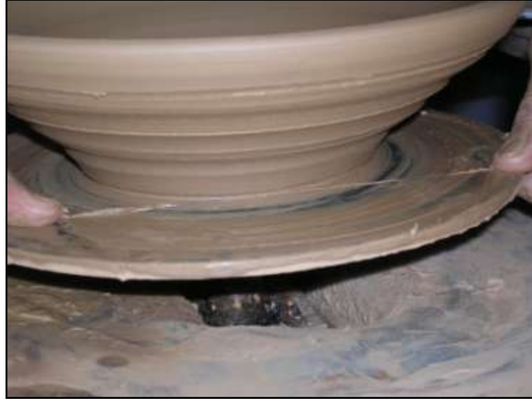
Resim: 54:Kabin Dibinin İple Kesilişi
