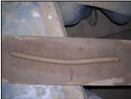
Resim 74:Kulp iki elle açıldıktan sonra, uç kısım kabın içine girecek şekilde inceltiliyor.
