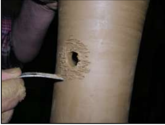
Resim 72:Kulbun geçireleceği kısma ince yivler açılır
