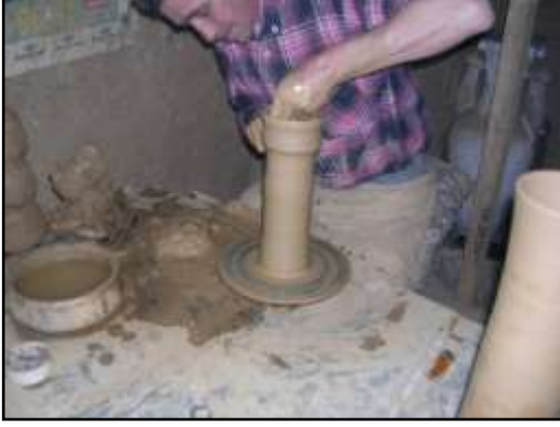
Resim 60: Tersten yapma yöntemi 1. aşama Resim 61: Tersten yapma yöntemi 2. aşama
