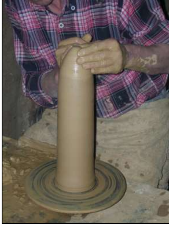
Resim 64: Tersten Yapım yöntemi 5. aşama
