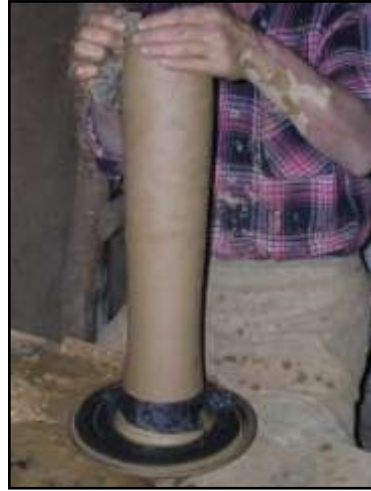
Resim 71:Erkek kalıpta depasın dip kısmının şekillendirilişi
