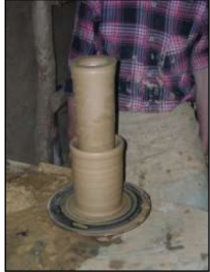
Resim 66: Depasın dişi kalıpta şekillendirilmesi
