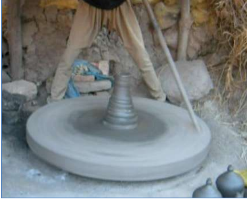
Resim 8: Uzun bir çubuk yardımıyla tablanın döndürülmesi
