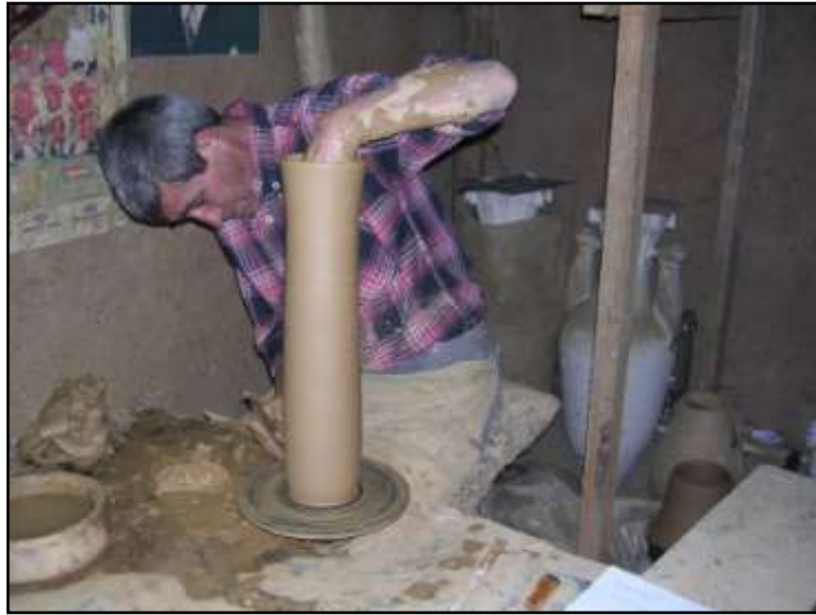
Resim 59: Kabın dibinin düzeltilmesi
