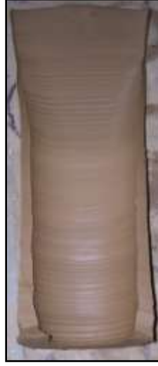
Resim 69:Düz yöntemle iki seferde yapılan depasın düzeltilmeden önceki profili
