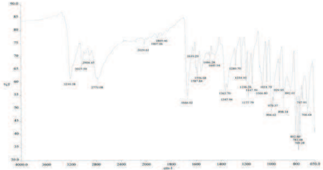
Şekil 2-2: Hidralazin hidroklorürün IR absorpsiyon spektrumu
