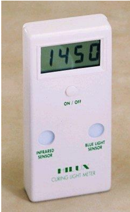
Şekil 3.10: Çalışmamızda kullanılan radyometre (Hilux Ledmax Light Curing Meter, Benlioglu Dental Inc, Ankara, Turkey)
