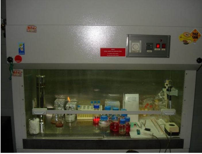
Şekil 3.2:Laminar akım hücre kültür kabini (Tezsan)
