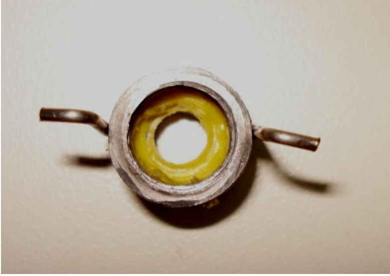
Şekil 3.18:Polivinilsiloksan ölçü maddesinin dentin bariyer test düzeneği dış parçasına uygulanmış hali
