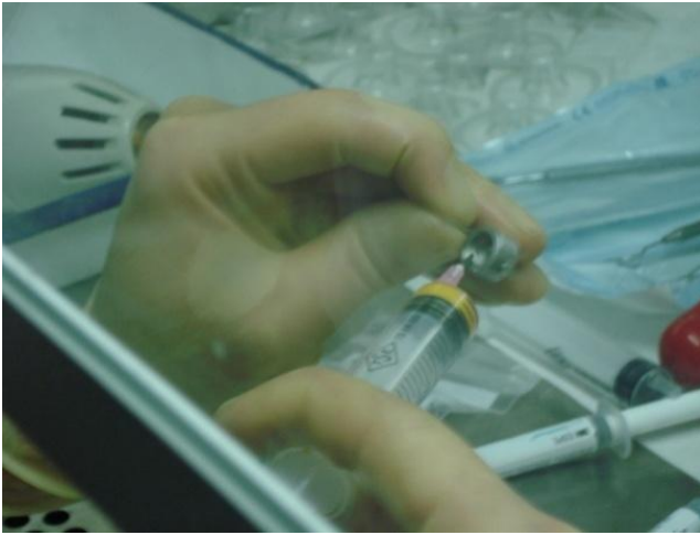
Şekil 3.17:Polivinilsiloksan ölçü maddesinin dentin bariyer test düzeneği dış parçasına uygulanması
