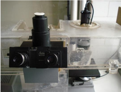
Şekil 3.4:Ters (İnvert) mikroskop (Leitz Wetzlar)
