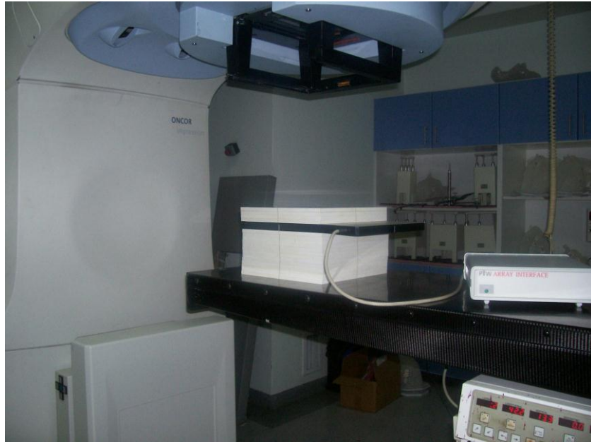
Şekil 3-5 2-D Array ile IMRT doğrulanması. 2D array RW3 katı su fantomunun arasına yerleştirilmiştir.
