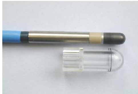
Şekil 3-4 PTW 0,125 cc semiflex iyon odası
