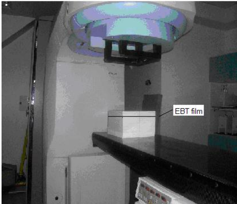
Şekil 3-6 Gafchromic EBT film ile IMRT doz dağılımı doğrulamasında ölçüm setinin görünümü
