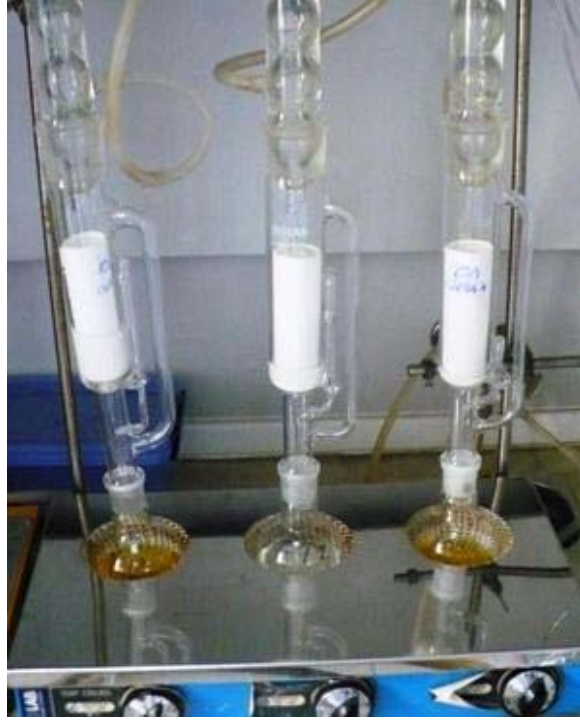
Şekil 3.1: Soxhlet ekstraktörüyle katı-sıvı ekstraksiyon işleminin yapılışı (orjinal)
