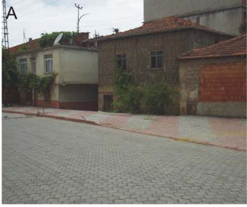
Foto: 76 A, B Sahil yolu kıyının doldurulması ile oluşturulan alandan geçmiştir. Sahil yoluna paralel yan yollarda yükseltilmiştir. İki yol arasında kalan evler yağışlardan sonra su basma tehlikesi ile karşı karşıya kalmışlardır.
