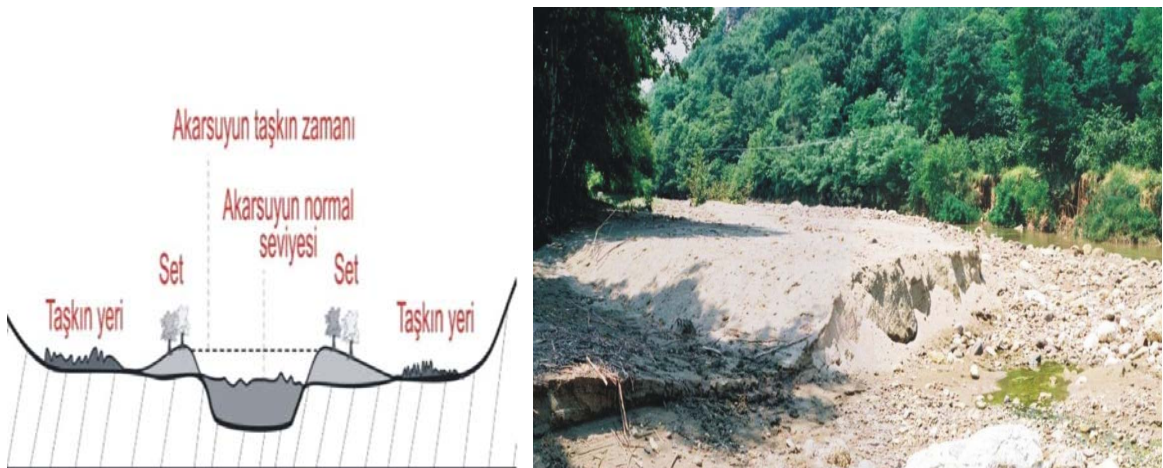
Foto:52 Çerkezler deresi; dere yatağı içerisinde biriken malzemeler yatak morfolojisini değiştirmektedir. Biriken mil, kum, çakıl boyutundaki malzemelerle yatak en kesit profili değişmekte, bu durum daha az su ile akarsuyun yatağı dışına daha kolay taşmasında neden olmaktadır.
