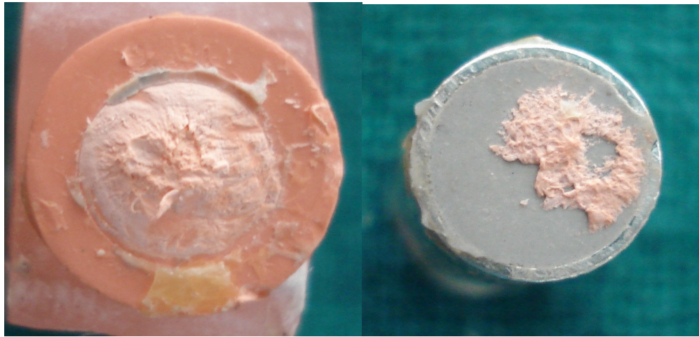
Şekil 4-43: 6. Grup'ta güta-perka yüzeyi ve AH26 sealer arasındaki karma kopma tipi
