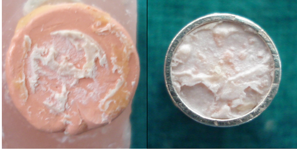
Şekil 4-46: 8. Grup'ta RealSeal sealer içerisinde görülen karma kopma tipi
