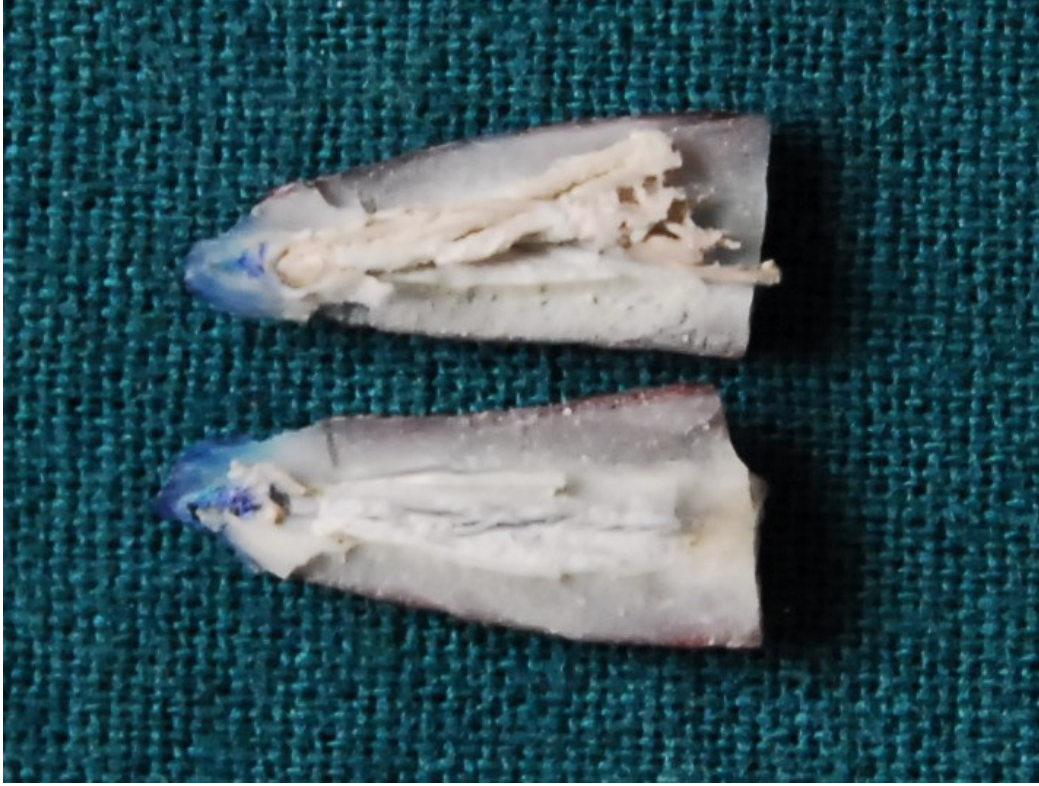
Şekil 4-51: 5. Grup'tan bir örneğin apikal kısmında izlenen linear boya sızıntısı (2,2 mm)
