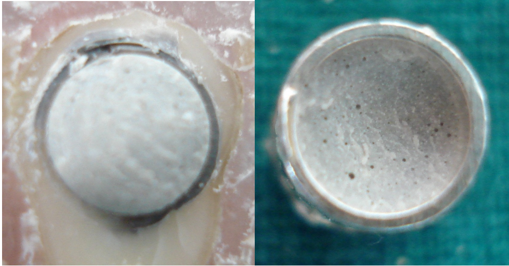
Şekil 4-39: 3. Grup'ta AH26 sealer içerisinde gerçekleşen koheziv kopma tipi
