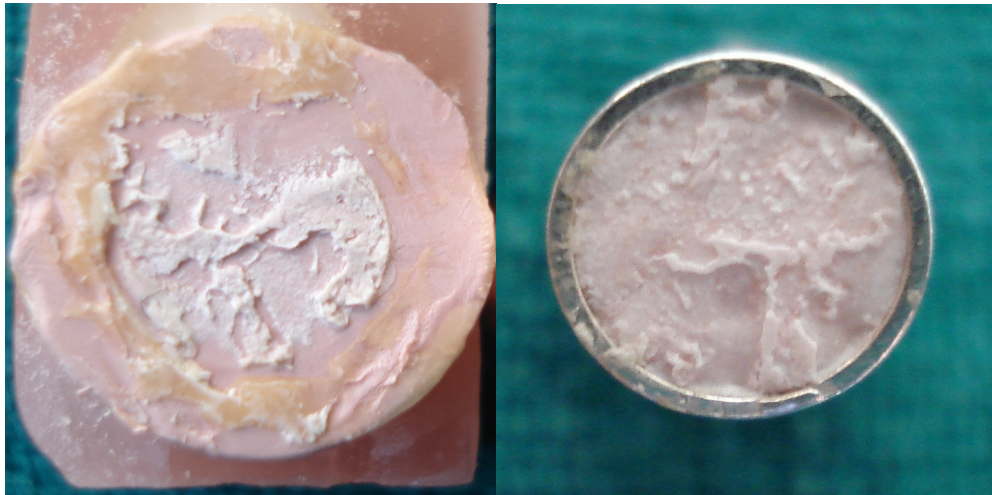
Şekil 4-45: 7. Grup'ta RealSeal sealer içerisinde görülen karma kopma tipi
