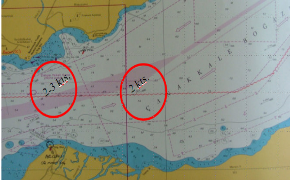
Şekil 36. Çanakkale Boğazi çıkışı yüzey akıntısı (SHOD INT 3750, 19.12.1998).
