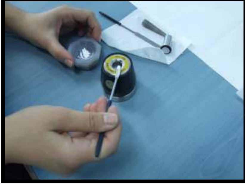
Şekil 3.16. Akrilik reçine deney örneklerinden elde edilen tozun KBr ile karıştırıldıktan sonra KBr pellet kiti içine yerleştirilmesi
