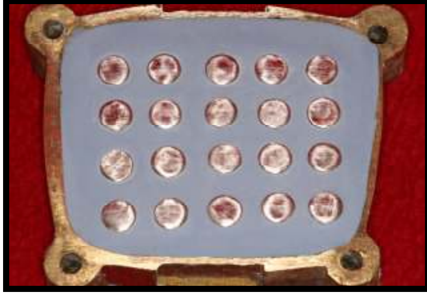
Şekil 3.4. Kalıp boşluklarının oluşturulması için paslanmaz çelik disklerin mufladaki görünümü
