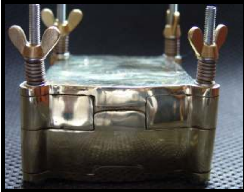
Şekil 3.2. Deney örneklerinin hazırlanmasında kullanılan pirinç muflarının görünümü
