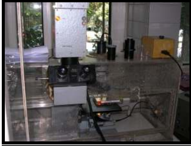
Şekil 3.30. Hücre kültürlerinin incelendiği faz kontrast invert mikroskop
