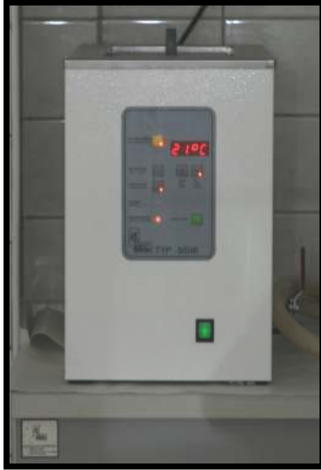
Şekil 3.8. Termostatik olarak kontrol edilebilen su banyosu
