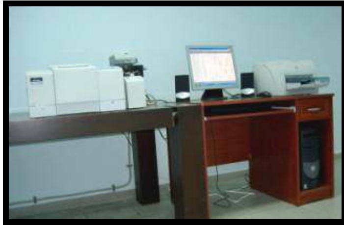
Şekil 3.14. Monomerin polimere dönüşüm oranının belirlenmesinde kullanılan FTIR spektrometresi cihazının genel görünümü
