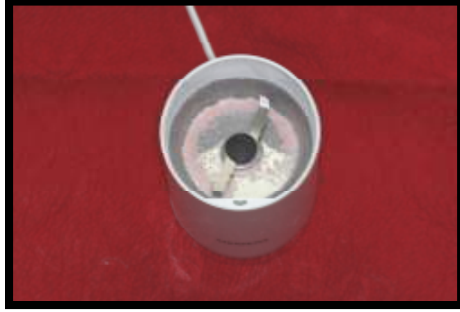
Şekil 3.13. Polimerizasyon işlemleri sonrasında mekanik yolla öğütülen akrilik reçine örneklerin toz haldeki görüntüsü
