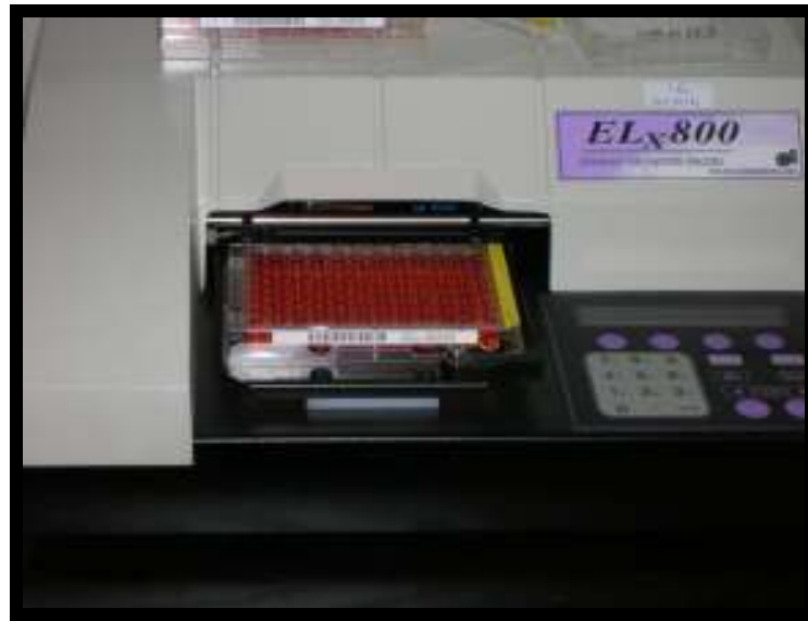
Şekil 3.34. Elisa mikrolaka okuyucusuna yerleştirilen 96 kuyucuklu mikrolakalar
