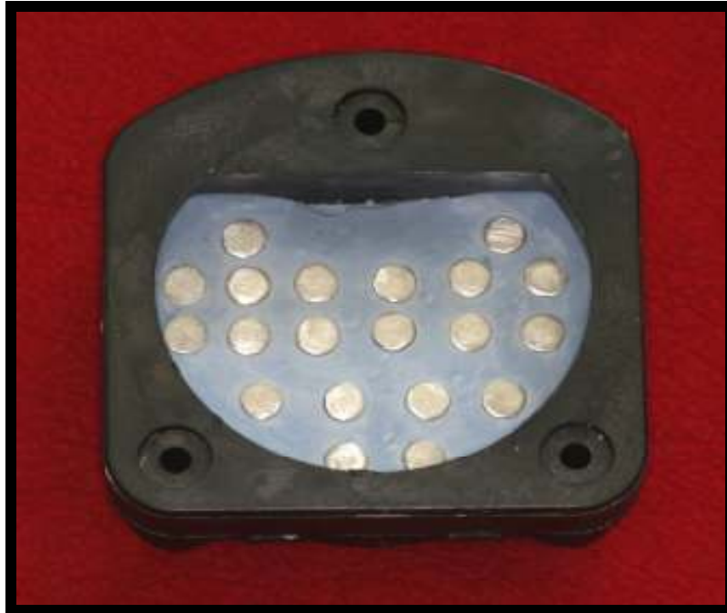
Şekil 3.9. Kalıp boşluklarının oluşturulması için paslanmaz çelik disklerin fiberle güçlendirilmiş plastik mufla içindeki görünümü
