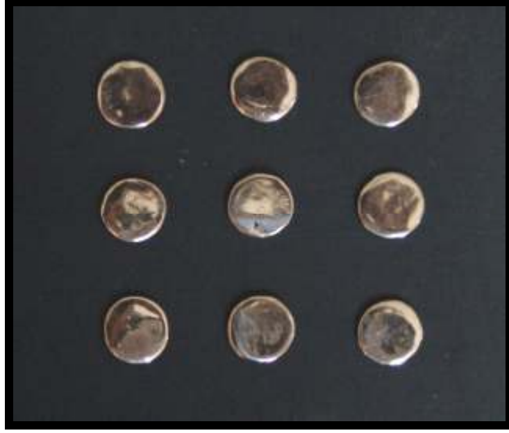
Şekil 3.1. Kalıp boşluklarının oluşturulmasında kullanılan disk şeklindeki paslanmaz çelik örnekler
