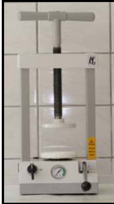
Şekil 3.5. Akrilik reçine örneklerin hazırlanmasında kullanılan hidrolik pres
