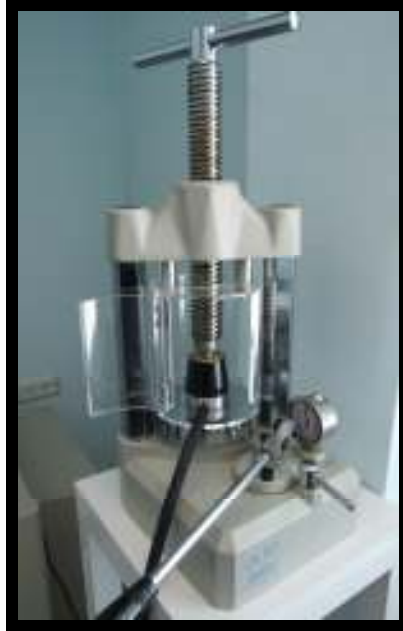
Şekil 3.17. KBr pellet kitinin hidrolik pres altında bekletilmesi
