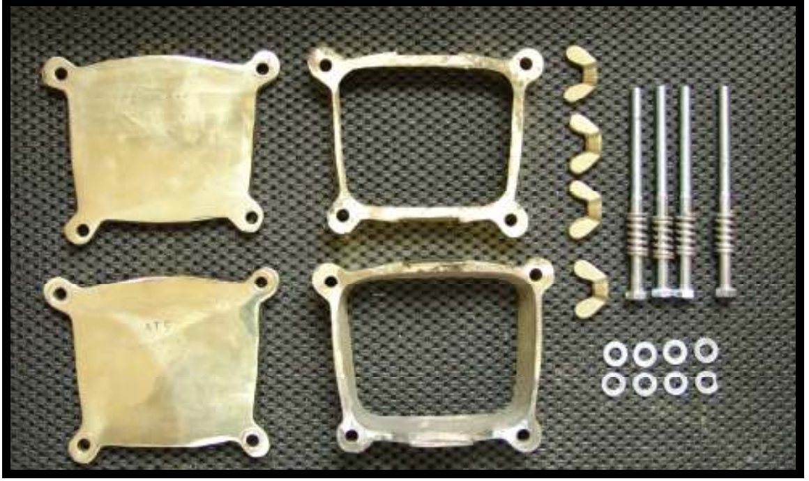
Şekil 3.3. Deney örneklerin hazırlanmasında kullanılan pirinç muflaların parçalarının görünümü
