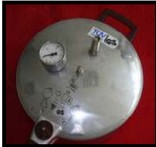
Şekil 3.12. Kimyasal yolla polimerize olan akrilik reçine örneklerin polimerizasyonunda kullanılan basınçlı tencerenin yandan ve üstten görünümü
