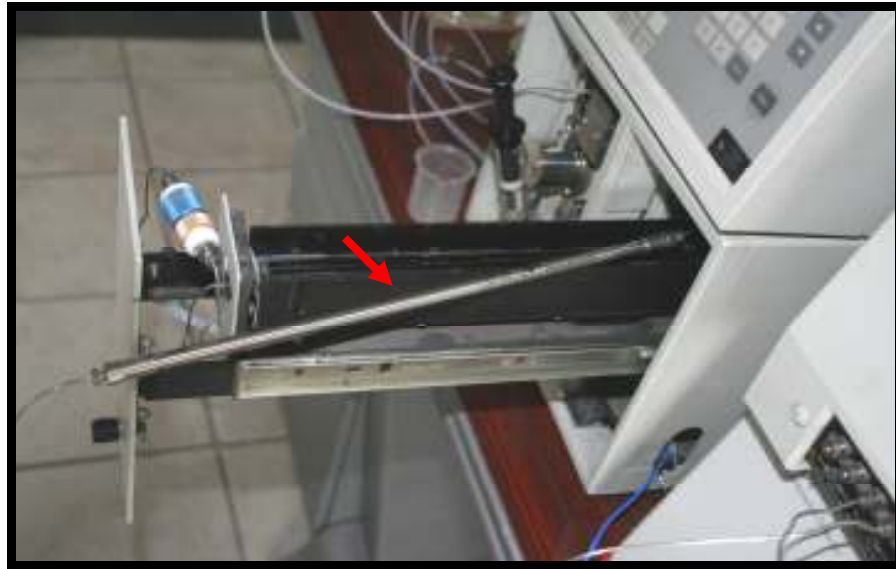
Şekil 3.26. Yüksek performanslı sıvı kromatografisi yönteminde kullanılan paslanmaz çelik analitik kolon
