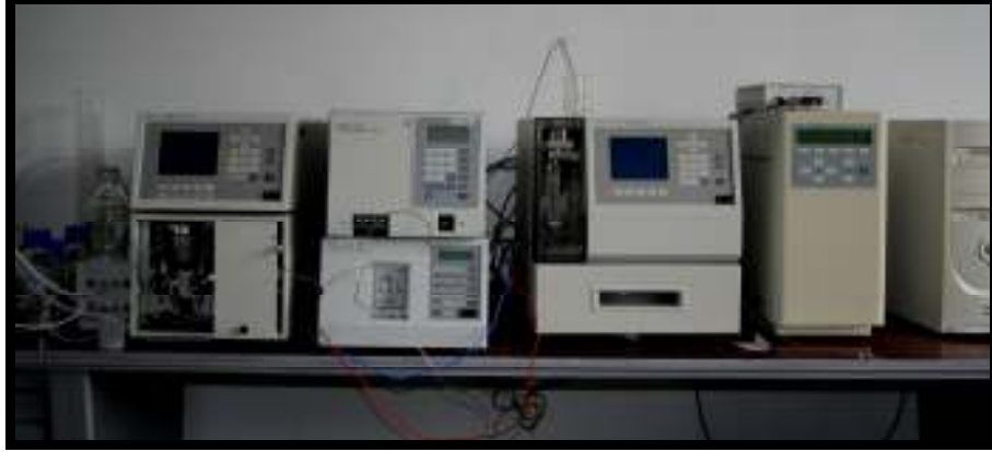
Şekil 3.25. Artık MMA'nın belirlenmesinde kullanılan yüksek performanslı sıvı kromatografisi cihazı (HPLC)
