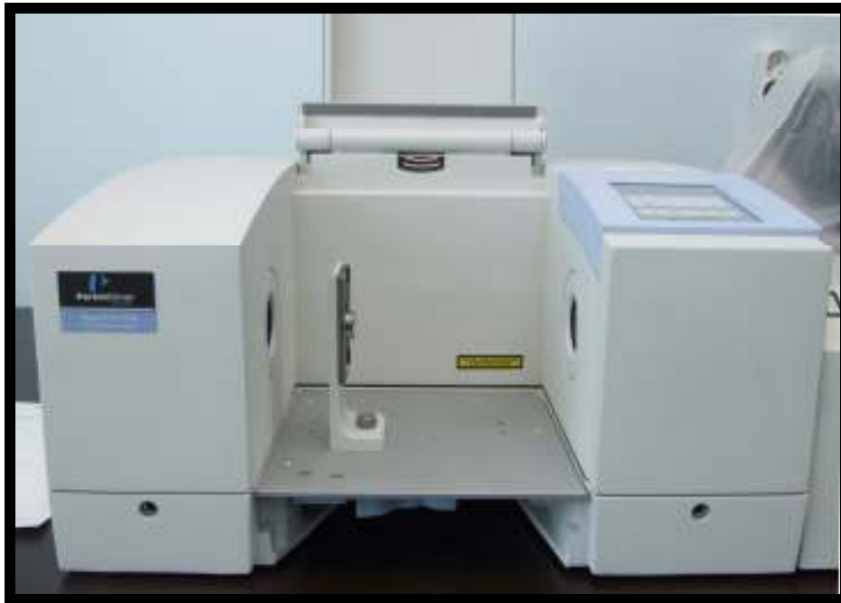
Şekil 3.15. Monomerin polimere dönüşüm oranının belirlenmesinde kullanılan FTIR spektrometresi cihazının yakın görünümü
