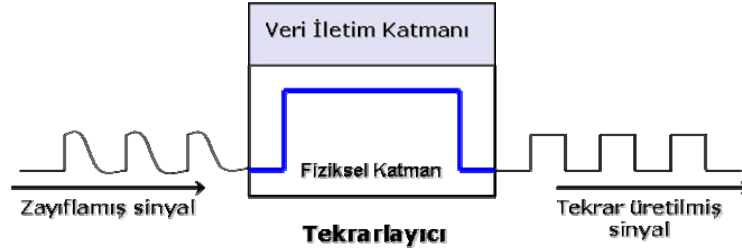
Şekil 2.1.4.1 : Tekrarlayıcının işlevi ve OSI modelindeki yeri
