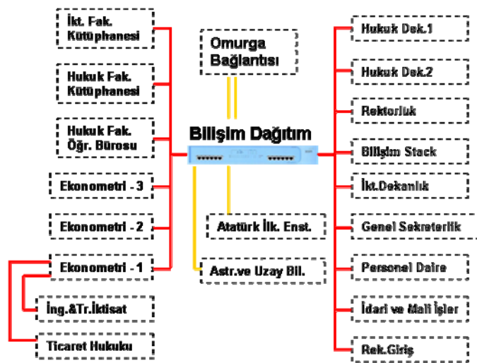
Şekil 2.2.2.2 : Bilişim Dağıtım anahtarı ve ona bağlı merkezler
