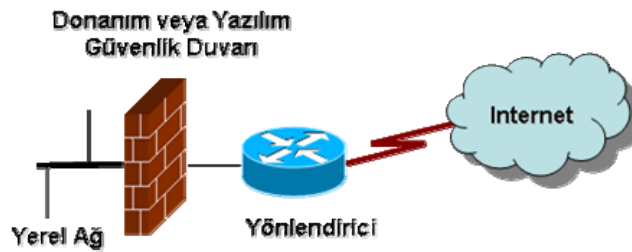
Şekil 5.1.1.3 : Tek güvenlik duvarı yerleşimi
