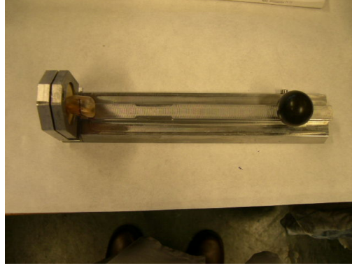
Şekil 13. İmplantların kesit cihazına yerleştirilmesini sağlayan hareketli parça içine konması
