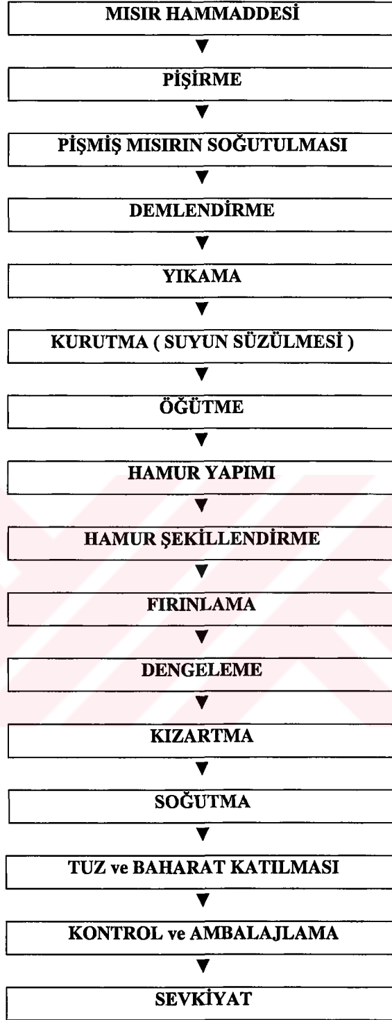
Şekil 2 : Tortilla tipi Mısır cipsi üretimiyle ilgili akış şeması
