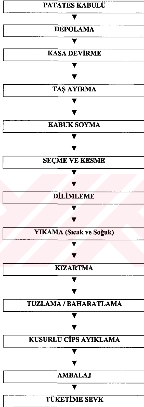
Şekil 1 : Patates cipsi üretimiyle ilgili akış şeması
