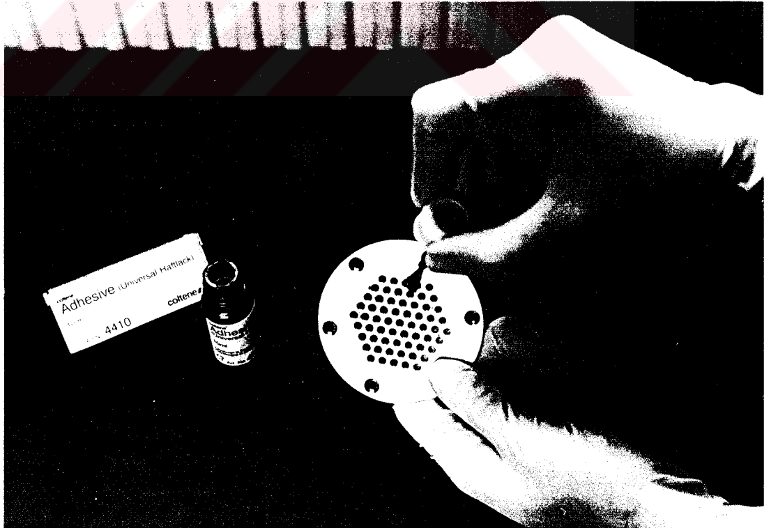
Şekil 37: Deney plakasına adheziv uygulanması.
