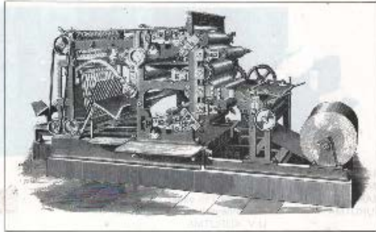
Şekil 2. 51. : İlk Alman gazete (tip) rotasyon baskı makinesi
