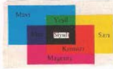
Şekil 2. 49. : Çıkarmalı renk karışımı
