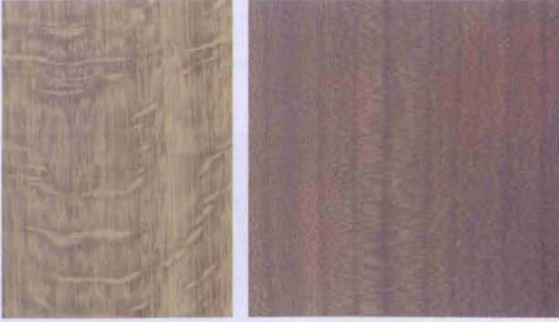
(A) (B) Şekil 2.19: (A) Meşe'de, (B) Karaağaç'ta aynalı görüntüş.
