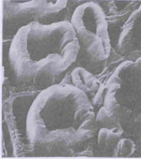
Şekil 9.17: Kavakta çekme odunu liflerinde boyuna daralma nedeniyle jelâtin tabakasının gevşeyerek uzaması (SEM, 3000x).
