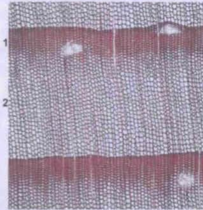
Şekil 2.5: Pinus sylvestris 'te ilkbahar odunu (2) ve yaz odunu (1) tabakasındaki hücrelerin (traheidlerin) çeper kalınlıklarındaki farklılık nedeniyle yıllık halka sınırının belirgin oluşu.
