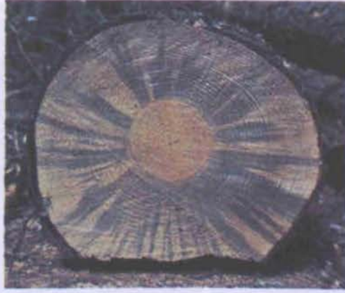
Şekil 10.3: Çam gövdesi enine kesitinde mavi renk oluşumu.
