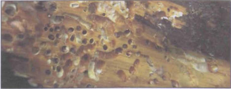
Şekil 10.13: Yumuşakçalardan Teredo navalis tarafından tahrip edilmiş bir ağaç malzeme.
