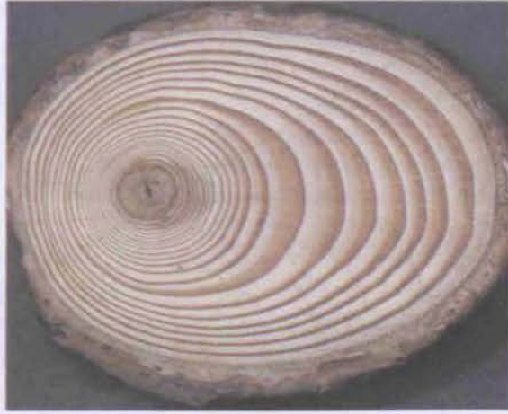
Şekil 9.11: Larix decidua 'da eksantrik gövde enine kesiti ve basınç odunu.
