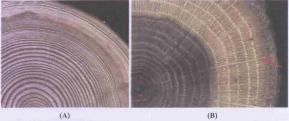
Şekil 2.11: (A) Pinus spp. enine kesiti, öz ışınları çok ince olduğundan görülmemekte, (B) Quercus macrocarpa enine kesitinde geniş öz ışınları.
