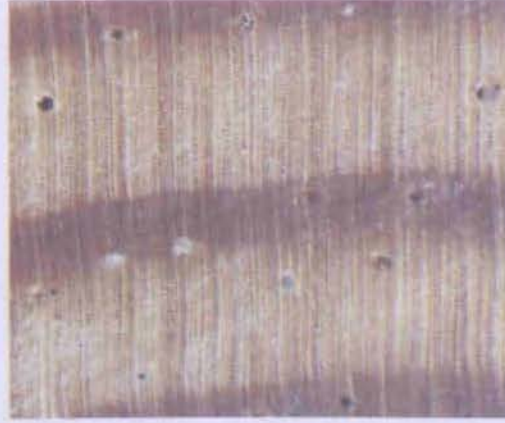
Şekil 2.12: Pinus spp. enine kesitinde boyuna reçine kanallarının görünümü.
