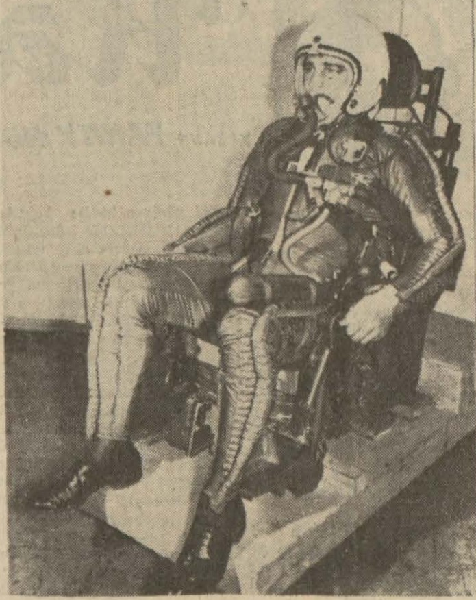
Çok yükseklerde uçacak olan uçaklardaki pilotlar için yeni bir elbise tipi meydana getirilmiştir. Yukarıdaki resimde altı yılda tekâmül ettirilen bu yeni elbise görülmüyor.
