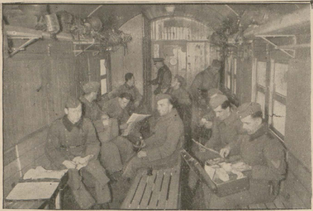
Um die Leistungsfähigkeit der Deutschen Reichsbahn zu erhöhen, und trotzdem den Soldaten eine bequeme Reisemöglichkeit zu geben, wurde ein kombinierter Personen- und Güterwagen entwickelt. Zusammenklappbare Längsbänke an den Außenwänden und in der Wagenmitte sorgen für Bequemlichkeit. Gepäcknetze, Propangasbeleuchtung und Lüftungskappen vervollständigen die Ausrüstung. Zum Schutze gegen Kälte und Wärme ist der Wagen doppelt verschalt und mit verschließbaren Fenstern versehen. Er hat als Personenwagen 55 Sitzplätze und als Güterwagen ein Ladegewicht von 19 Tonnen.
