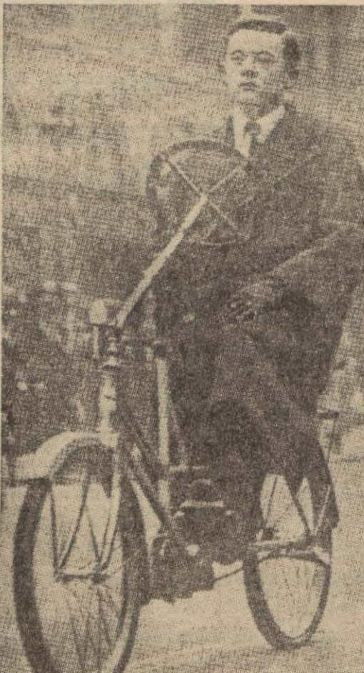
Bisikletlerin başlıca güçlüğü iki kat olarak gidonu kullanmak mecburiyeti idi. Son zamanlarda bunun yerine otomobil direksiyonuna benziyen bir direksiyon konmuştur. Bu suretle eğilmeden bisikleti de idare etmek kabil olmaktadır.
